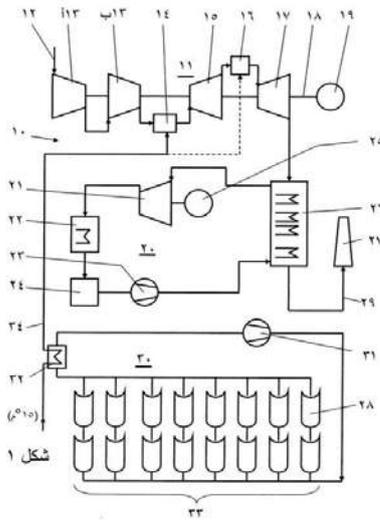
في محطة طاقة (10) والتي تكون مجهزة بتوربين غاز (11)، يكون الوقود لتوربين الغاز (11) مسخن عن طريق الحرارة الشمسية. يتم عمل التسخين من خلال استخدام دائرة تحويل حراري (37). بالإضافة إلى ذلك، دائرة تحويل حراري ثانية بين المصدر (33) للحرارة الشمسية ودائرة التحويل الحراري الأولى (37) تسمح بتخزين الحرارة الشمسية. تسخين الوقود وفقاً للإختراع يسمح بشكل خاص بزيادة كفاءة محطة الطاقة (10).
